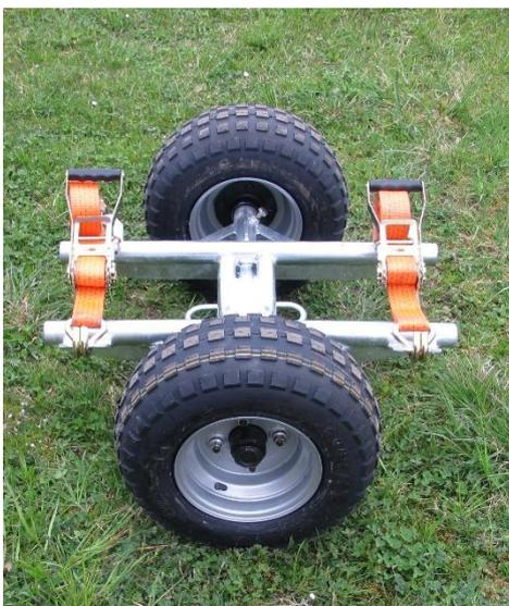
Dank den starken, verstellbaren Laufachsen und den optimalen Rädern kann der Rohrtransport-Wagen auch in unwegsamem Gelände eingesetzt werden.
